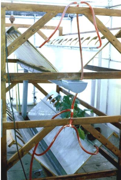
Figuur 11. De “muggenzifter”, opstelling voor het verzamelen van galmuglarven in gekoeld rondstromend water.
