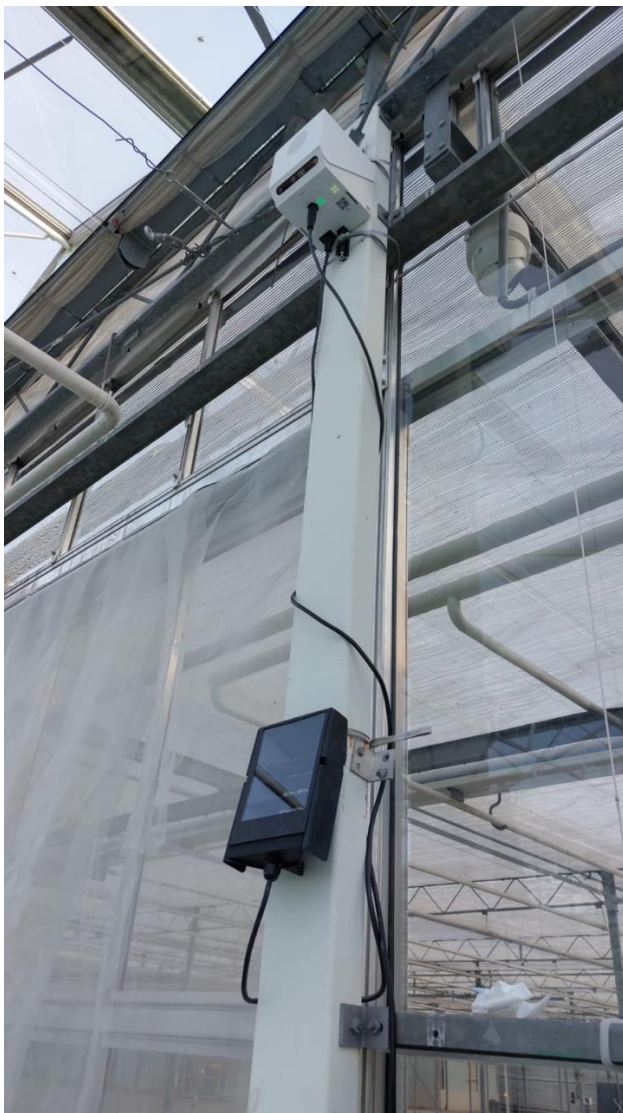
Figuur 8: PAT-C detectiesysteem zoals gemonteerd in de proefkas
